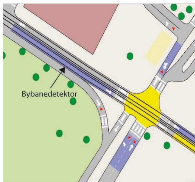
Figur 3-3: Bybanedetektor i signalanlegg
